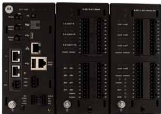
Unidade Terminal Remota ACE1000 sem tampas
